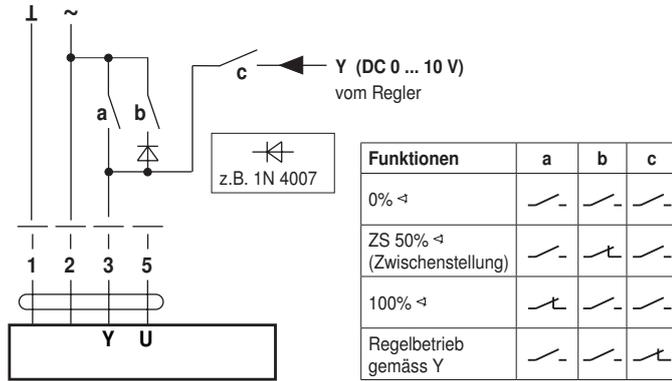
Zwangsteuerung mit AC 24 V mit Drehschalter
