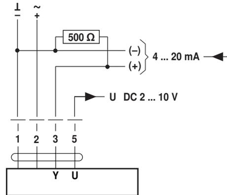
Der 500 Ω-Widerstand konvertiert das 4 ... 20 mA-Stromsignal in ein Spannungssignal DC 2 ... 10 V
